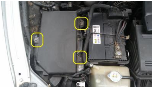
Schrauben der Steuergerät-Abdeckung lösen
