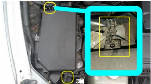
Kabel-Clips von einer oder beiden Seiten lösen
