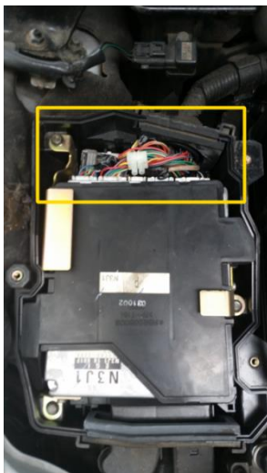
Schrauben der Steuergerät-Abdeckung lösen
